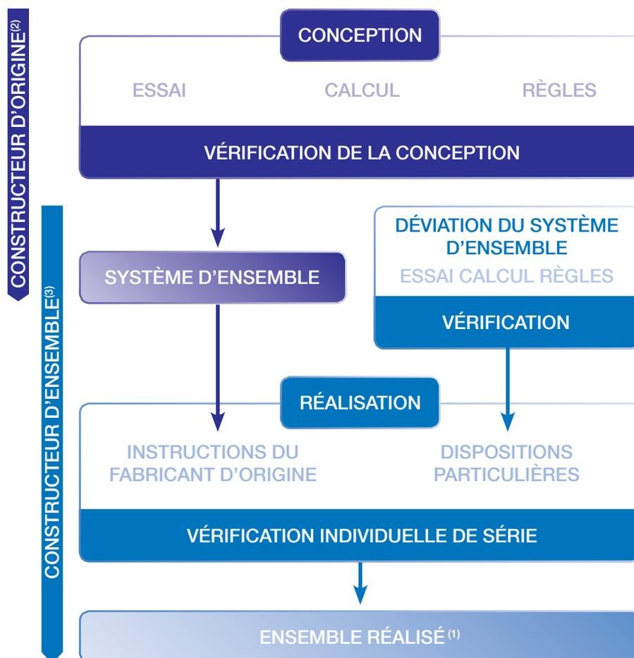
(1) **Ensemble** : système complet de composants électriques et mécaniques tel que les enveloppes, les jeux de barres, les unités fonctionnelles, etc.
