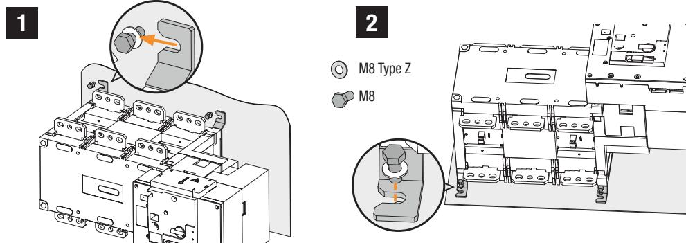
⚠ Attention : le produit doit toujours être installé sur une surface plane et rigide.
