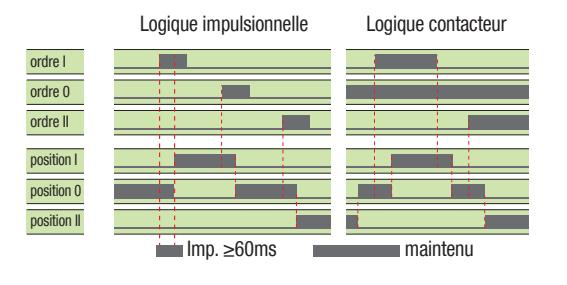
Pour permettre le contrôle, fermer le contact 312 avec le 317. Pour affecter la logique contacteur, fermer le contact 316 avec le 317. Pour atteindre la position souhaitée, fermer le contact correspondant. Pour forcer le produit en position 0 prioritaire, fermer le contact 313 avec le 317.
