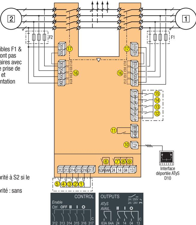
Raccorder le produit avec des câbles de 1,5 à 2,5 mm<sup>2</sup>.
