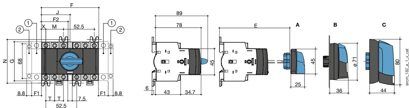
1. Emplacement pour: 1 pôle principal ou 1 contact auxiliaire (voir accessoires).
