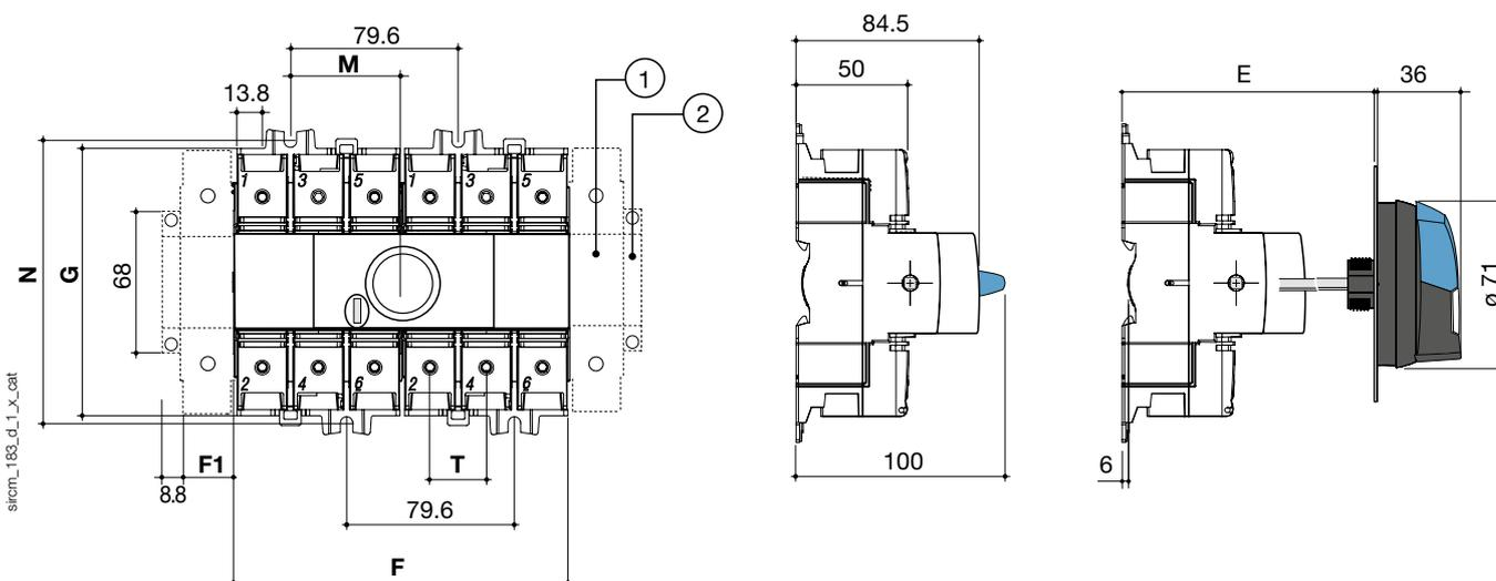
1. Emplacement pour: 1 pôle principal ou 1 contact auxiliaire (voir accessoires).
