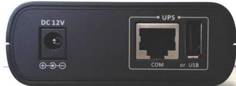
La liaison série avec l'ASI se trouve à l'arrière du boîtier. Le câble série fourni doit être raccordé au connecteur "COM" RJ45 et au port série RS232 DB9 de l'ASI.
