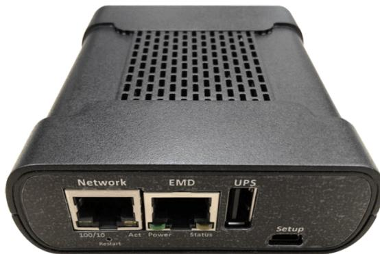
Le connecteur réseau RJ45 est utilisé pour la connexion au réseau Ethernet.
