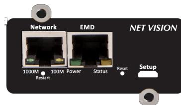
La carte NET VISION est installée et vissée dans un des slots COM disponibles. La façade métallique peut être adaptée pour fixer NET VISION au slot COM en fonction du modèle de l'ASI.
