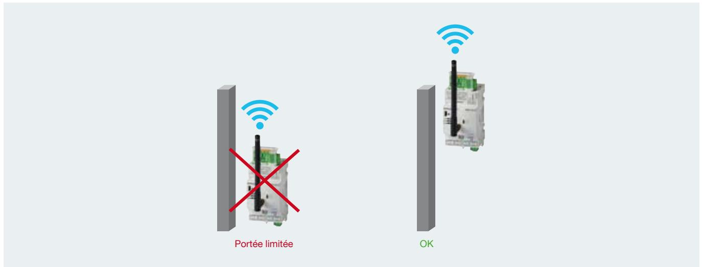
Exemple d'emplacements risquant de limiter la portée du signal RF :
