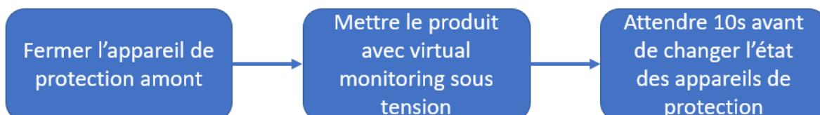
Pendant la phase de test, il est également recommandé de ne pas ouvrir et fermer de façon répétée les appareils de protection. En effet, l'algorithme de détermination de la présence de tension a besoin d'environ 5s pour délivrer une information fiable.
