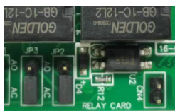
Figure 5 - Sérigraphie AO et AC indiquant l'état des connecteurs 3 broches
