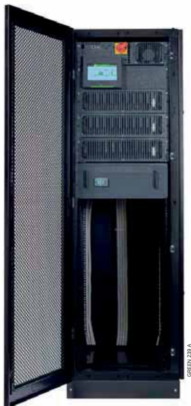
Exemple d'intégration (3 x 25 kW). Uniquement 15 U occupés : conception compacte, laissant un maximum d'espace disponible pour d'autres équipements montés en rack. Un slot vide dans le sub-rack MODULYS RM GP reste disponible pour l'augmentation de la puissance ou de la redondance.
